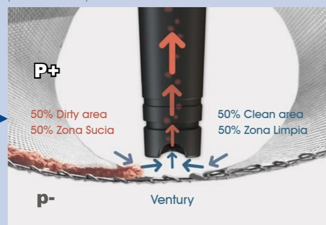
El cartucho LAMA, inyectado en poliamida con la mejor tecnología del mercado, tiene un rendimiento de superficie útil del 26,40%
