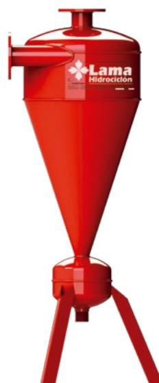
Los hidrociclones tienen un sistema muy simple, de fácil manejo y muy económico. La filtración se produce físicamente por retención de partículas con peso muy superior al del agua, debido a la fuerza centrífuga que provoca la misma al incidir a alta velocidad en el separador con una trayectoria tangencial. La suciedad se adhiere a las paredes del hidrociclón, cayendo a un depósito debajo del filtro.
